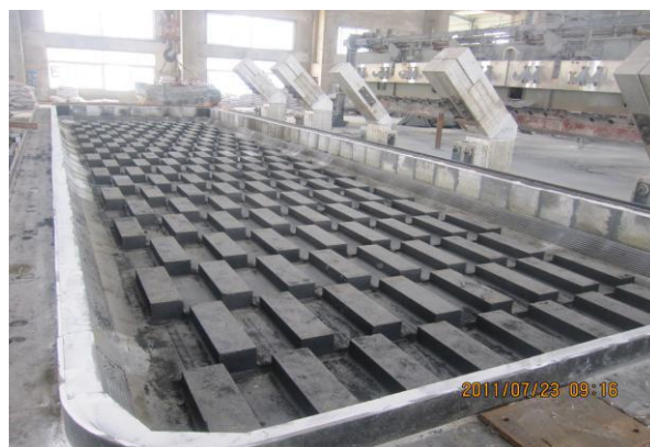
图 2 阴极碳块的上表面具有相互交错的横向凸起的电解槽
