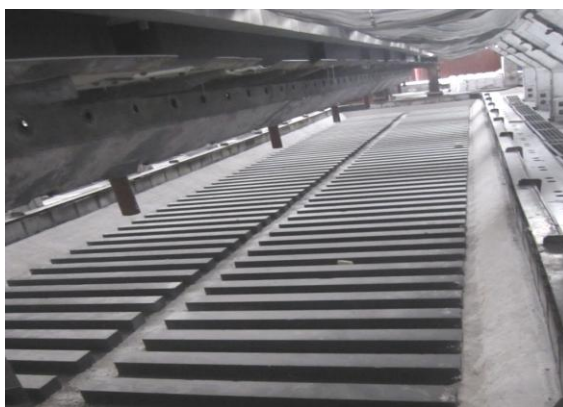
图 1 阴极碳块表面的纵向方向具有 2 个凸起结构的电解槽
